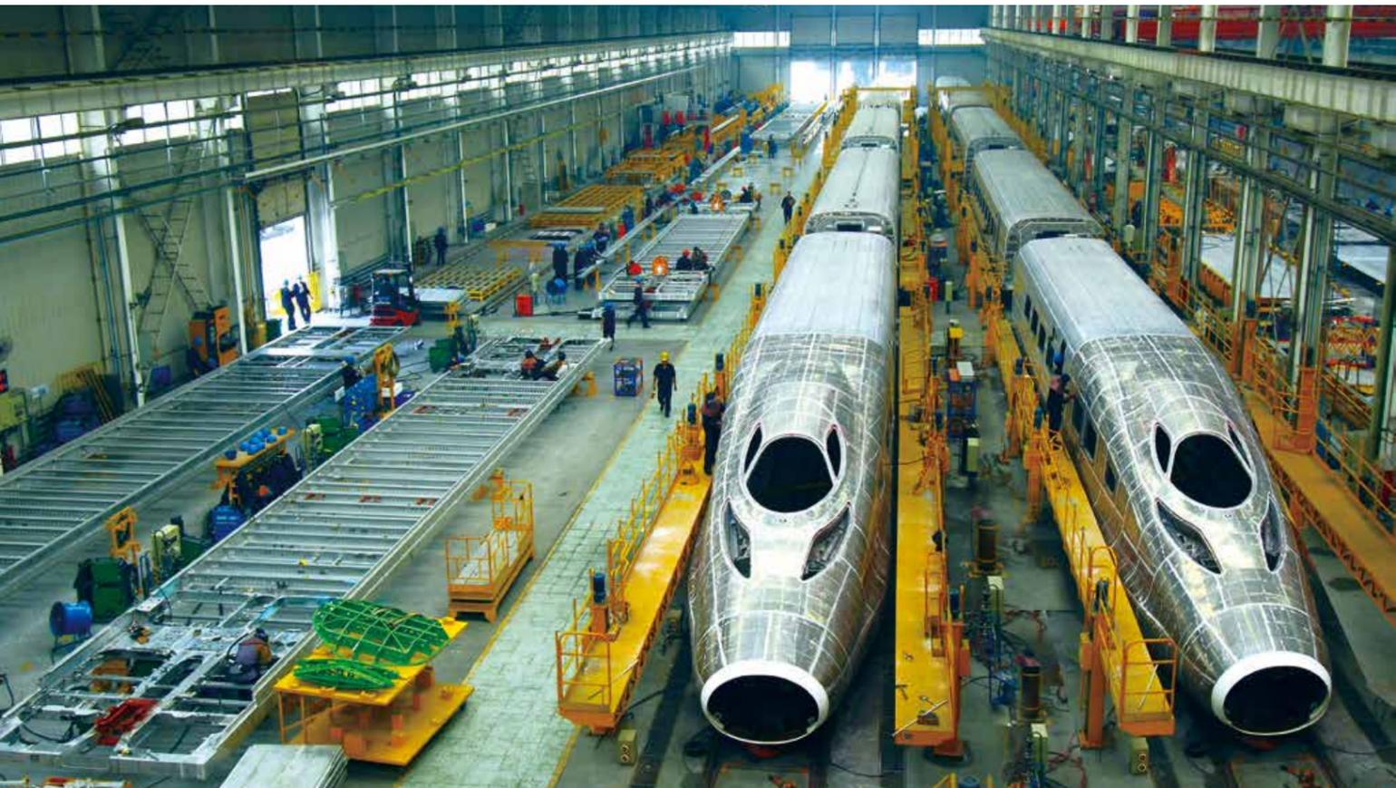
青岛中车四方高速动车组车体生产线(图/资料图片)
